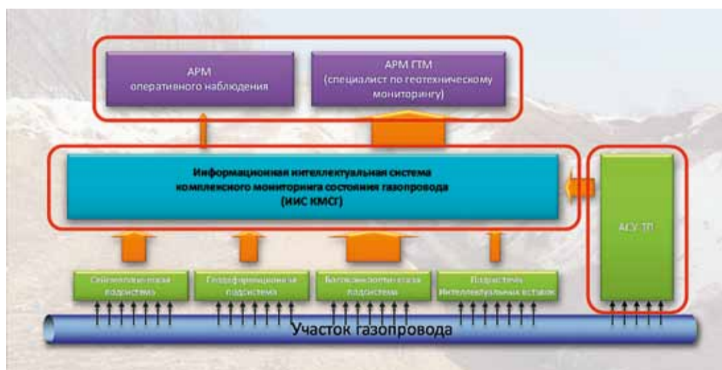
Обобщенная структура системы комплексного мониторинга состояния газопровода
